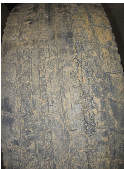
Иллюстрация 7: Механические повреждения
