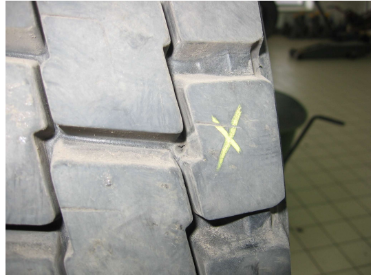
Иллюстрация 9: Некачественный ремонт сквозных повреждений
