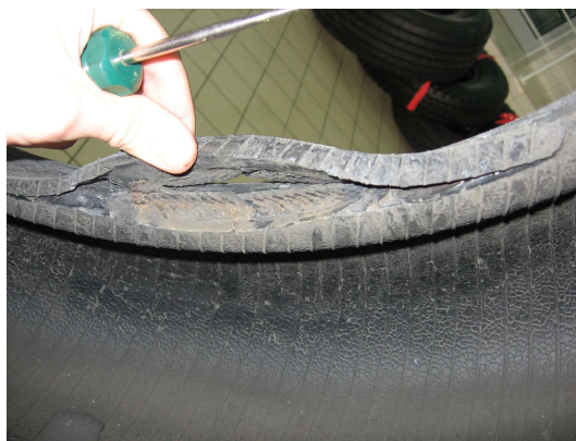
Иллюстрация 4: Механические повреждения бортового кольца
