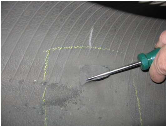
Иллюстрация 9: Некачественный ремонт сквозных повреждений
