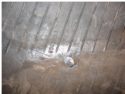
Иллюстрация 5: Повреждения внутренней полости шины
