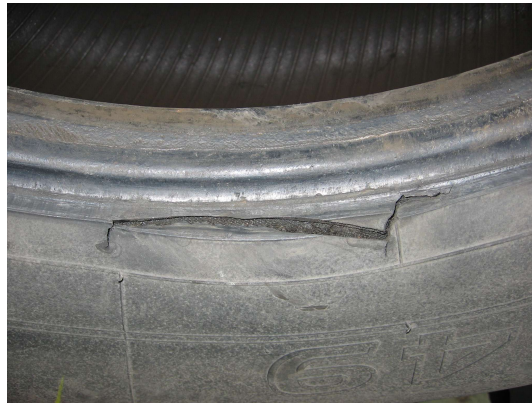
Иллюстрация 8: Повреждения надбортовой зоны
